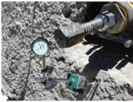
Figura 10. Lectura del dial sobre el extremo del perno
